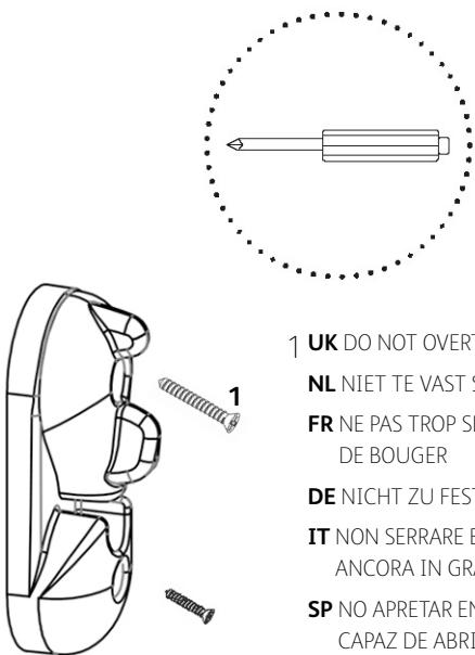
**1 UK** DO NOT OVERTIGHTEN SCREWS, THE LOCK MUST STILL BE ABLE TO MOVE
